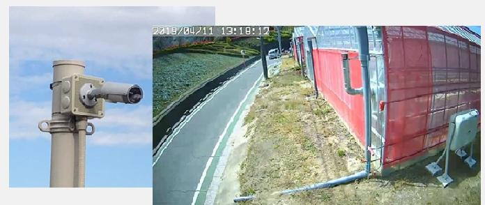
指定のメールアドレス(3 アカウント)、FTP サーバーへ静止画像を送信します。1 分単位で 24 時間に何回送信するか自由に設定可能です。
